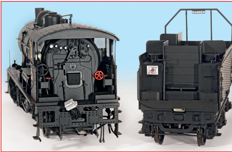
le foyer. Le rayon minimum d'inscription est de 1028 mm. Toutes les roues accouplées et celles du tender sont mises à contribution pour le captage du courant. L'éclairage selon le sens de marche délivre uniquement une lumière blanche par LEDs. La connexion électrique entre la machine et le tender, reliés par un timon à élancement, est assurée par une prise à 12 broches. Un boîtier normalisé pour enficher un attelage LENZ est présent à l'arrière du tender.
